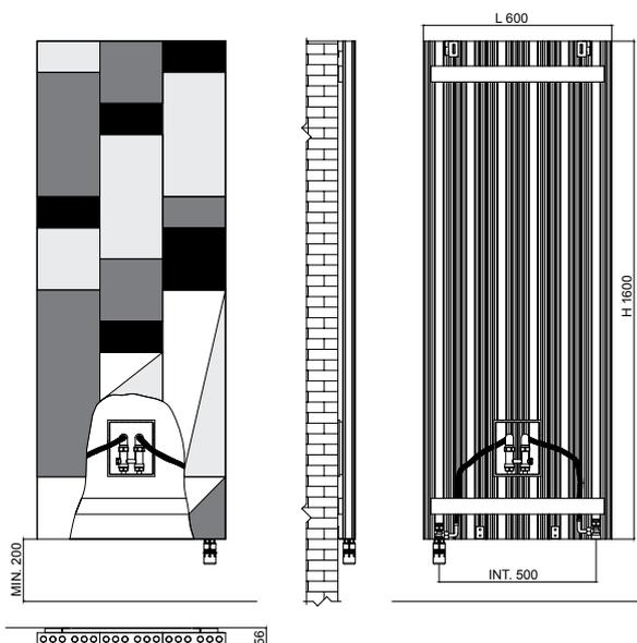
Collegamento ad acqua con attacchi a valvola ad "H"
