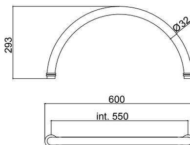
Arco superiore scaldante in tubo di ottone Ø 32 mm
