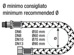
**4** Non installare il tubo con la parte flessibile in torsione.
