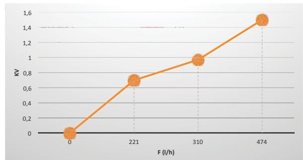
Prova eseguita determinando la portata in funzione della regolazione (chiusura volante) mantenendo  $\Delta P$  costante
