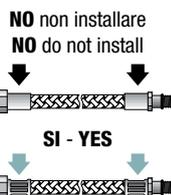
**2** Non installare il flex in treccia in tensione.
