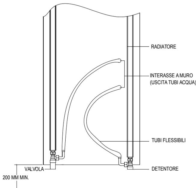
**1** Verificare che il bloccaggio di ambedue i raccordi al tubo sia fatto correttamente su tutti i tipi di flex in treccia.
