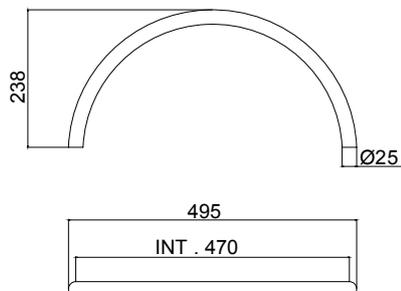
Arco superiore scaldante in tubo di ottone Ø 25 mm
