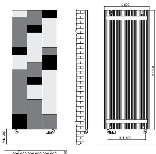
Collegamento ad acqua con attacchi ad interasse standard
