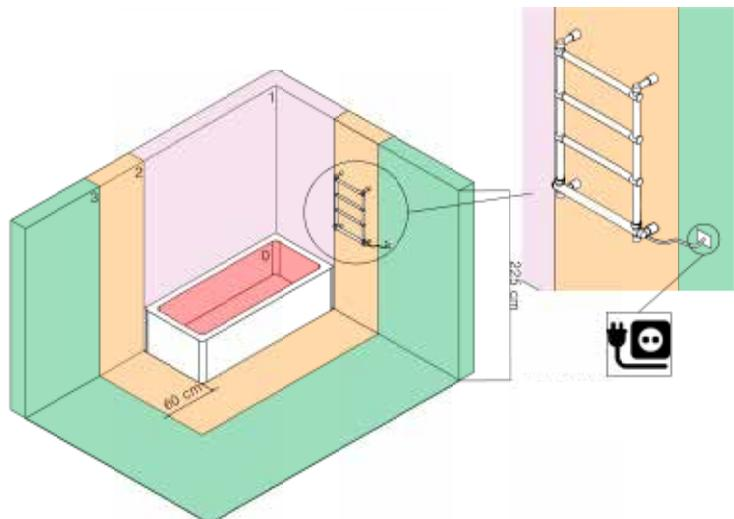
COLLEGAMENTO IN ZONA 3 CON PRESA SCHUKO E POSIZIONAMENTO SCALDASALVIETTE IN ZONA 2
