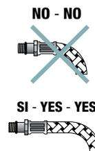
**6** Non installare il tubo con la parte flessibile murata. Installare solo in luoghi ispezionabili.
