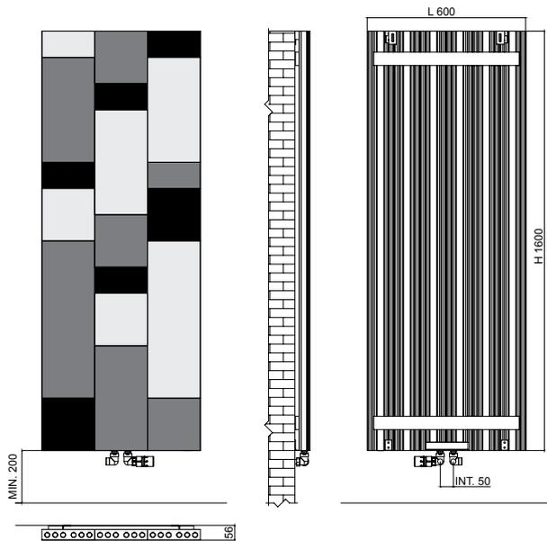
Collegamento ad acqua con attacchi centrali da 50mm
