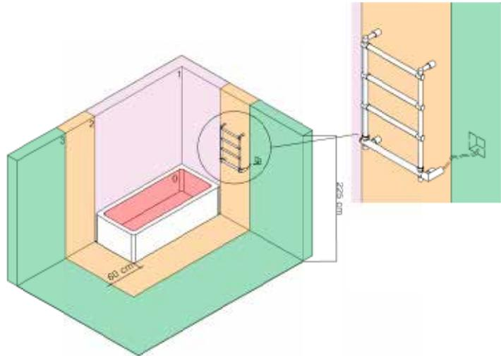
COLLEGAMENTO CON BOX CIEGO CON CAVO ELETTRICO E SCATOLA DI DERIVAZIONE IMMURATI E POSIZIONAMENTO SCALDASALVIETTE IN ZONA 2
